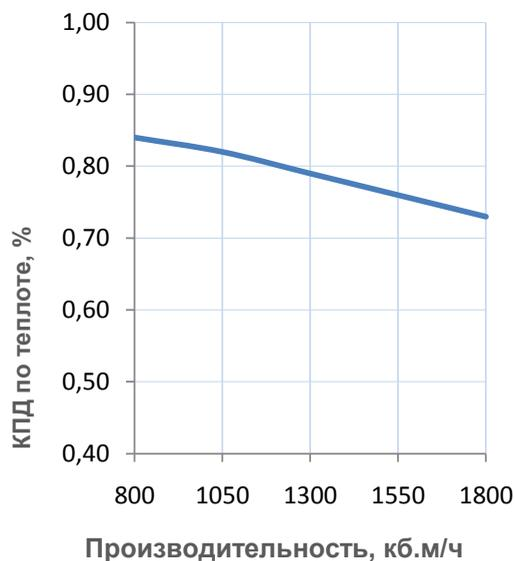
\* Указана производительность приточного канала. Производительность вытяжного канала может регулироваться в диапазоне от 30% до 100% производительности приточного канала.
