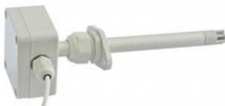
Цифровой датчик температуры и влажности с выходом Modbus RTU, в комплекте кабель длиной 5 метров с разъёмом RJ-12. Датчик предназначен для использования совместно с увлажнителями (секциями увлажнения) Breezart с нагревателями. Позволяет реализовать пропорциональное управление увлажнителем для точного поддержания уровня относительной влажности воздуха. Датчик JLS30HC имеет защиту IP54.
