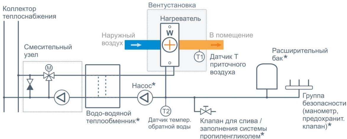
Смесительный узел с датчиком T2 (температуры обратной воды) для моделей до 8000 типоразмера включительно входит в состав и стоимость вентустановки. Для моделей от 10000 типоразмера и выше смесительный узел приобретается отдельно.
