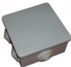
Модуль управления клапаном (соединительная коробка) CB-02, 24В - 20мА. Позволяет управлять заслонкой клапана с помощью привода с пропорциональным управлением. Для управления модулем используется регулятор (потенциометр) JLC100. Напряжение питания DC 24V. Может транслировать от привода сигнал 0–10В, показывающий текущее положение заслонки.
