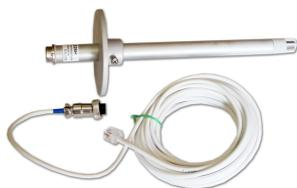
Цифровой датчик температуры и влажности с выходом Modbus RTU, в комплекте кабель длиной 5 метров с разъемом RJ-12 для подключения к порту P1 увлажнителя или вентустановки. Датчик предназначен для использования совместно с увлажнителями (секциями увлажнения) Breezart с нагревателями. Позволяет реализовать пропорциональное управление увлажнителем для точного поддержания уровня относительной влажности воздуха.
