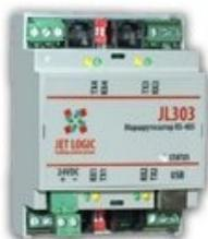
Многофункциональный маршрутизатор / разветвитель для шины ModBus:
