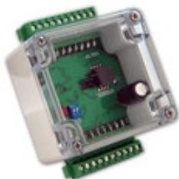
Модуль распределенного управления. Позволяет управлять заслонкой клапана с помощью привода с пропорциональным управлением. Для управления модулем может использоваться регулятор (потенциометр) JLC100. Напряжение питания DC 24V. Особенности:
